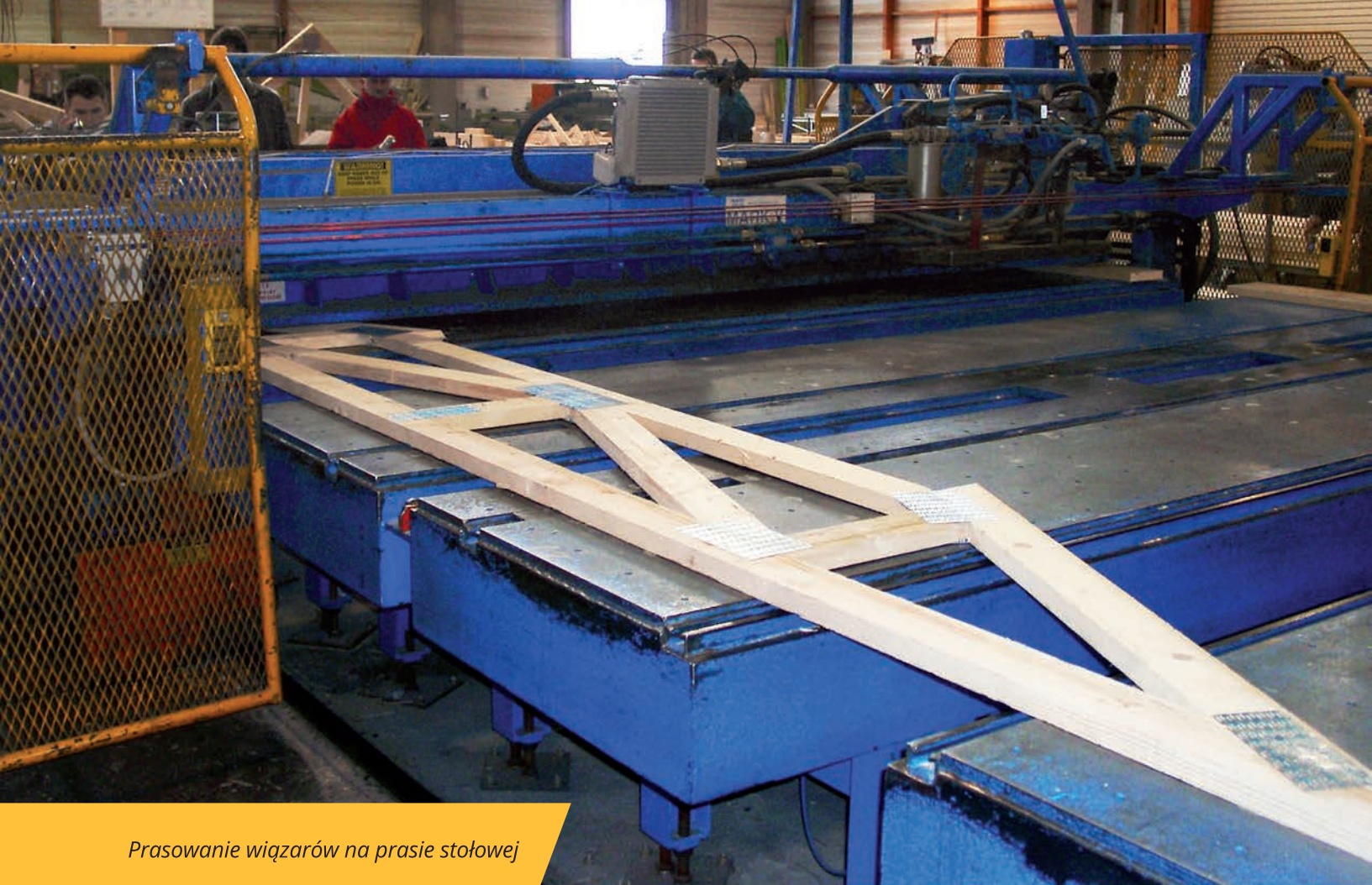
Projektor laserowy nad stanowiskiem prasowania ułatwia ułożenie szablonu więzara oraz umiejscowienie płytek w węzłach
